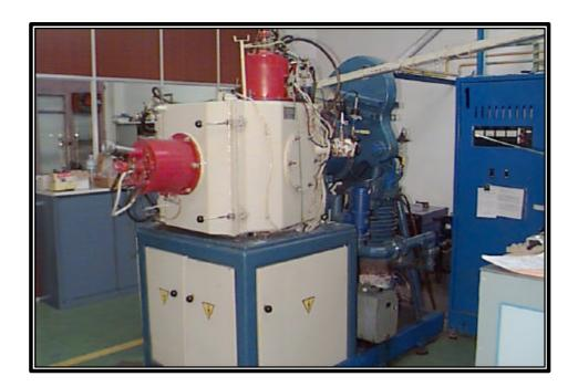
Durante el proceso de recubrimiento se consigue un alto vacío dentro de la cámara, por lo tanto tiene que estar herméticamente cerrada y sin la posibilidad de dejar entrar aire dentro, ya que el oxigeno contenido por este nos oxidaría las piezas, que durante la fase de recubrimiento están a una temperatura que oscila los 500 °C.
