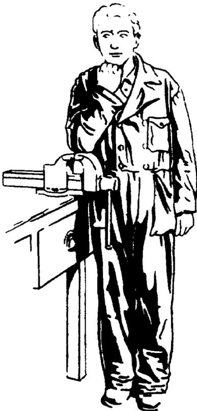
Un factor importante a tener en cuenta para la práctica del limado es el aspecto ergonómico del puesto de trabajo, y en concreto el de la altura del tornillo de banco que para evitar esfuerzos o posturas inadecuadas debe de tener la posición indicada en la figura.
