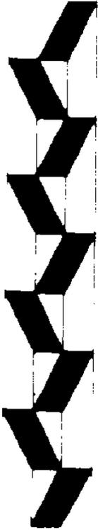
En el que las disposición de los dientes es triscada para evitar el rozamiento con los laterales.
